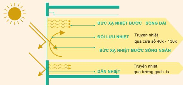
Để tiết kiệm năng lượng làm mát, cần ngăn bức xạ mặt trời đi vào bên trong công trình bằng cách:
